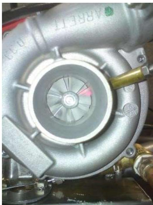
En fonction des environnements et des contraintes des clients, il existe des cas de figure où la sonde n'est pas installée dans le corps du turbocompresseur mais à la sortie ou l'entrée du compresseur.
