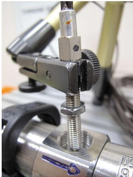
Cas client : conception d'une sonde pour installation dans l'emplacement prévu pour une sonde PT1000.
