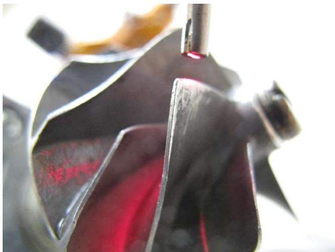
L'exemple ci-dessus montre une sonde dite « SLIT », capable de détecter sur la tranche des pâles ou des splitters dont l'épaisseur est de l'ordre de 1mm.
